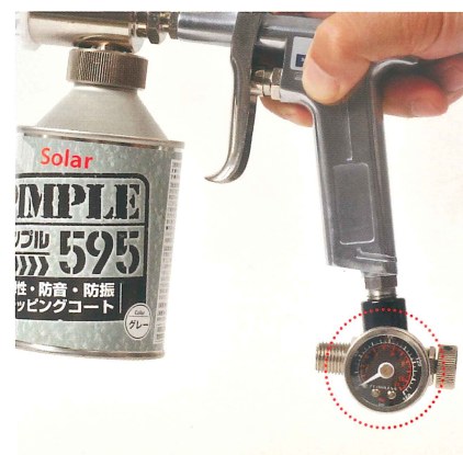
レギュレーター(別売)で 空気圧を0.3~0.5MPaに設定
