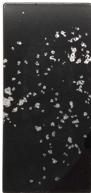
グラヘロ試験 6号砕石 500g 0.3MPa 剥がれ発生
