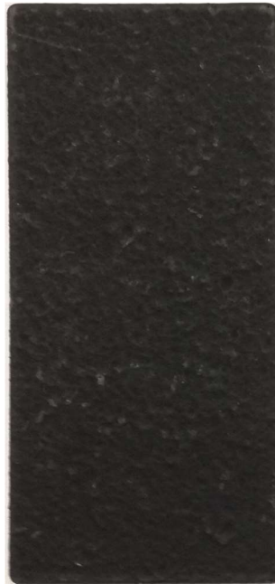
グラヘロ試験 6号砕石 500g 0.3MPa 剥がれなし
