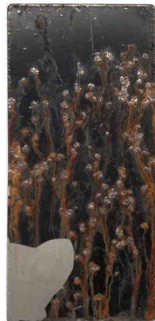
グラヘロ試験後 塩水噴霧試験 200時間 点錆多数発生、剥がれ発生
