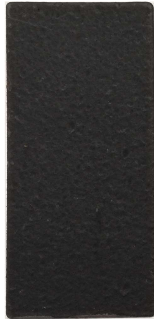
グラヘロ試験後 塩水噴霧試験 200時間 僅かに点錆発生
